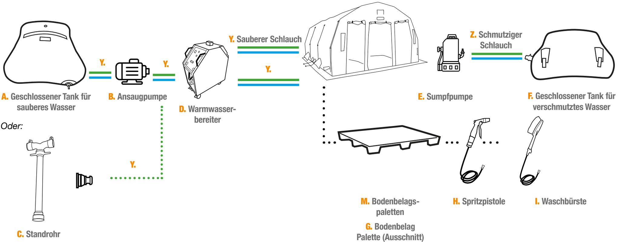
Verwendung einer Tender- oder Standrohrwasserversorgung.
